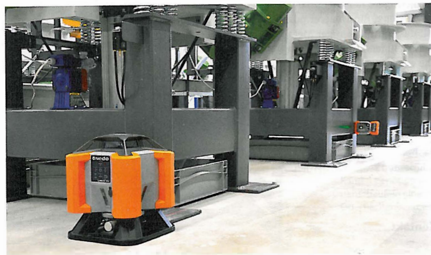
Der Universallaser verfügt neben einer horizontalen über vier vertikale Laserebenen und ermöglicht dadurch die exakte Ausrichtung von Maschinen.
