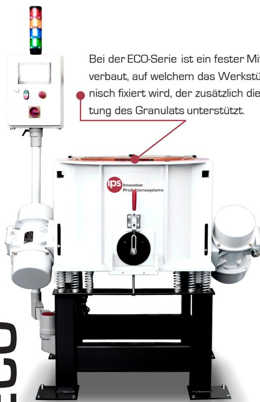
Bei der ECO-Serie ist ein fester Mitteldorn verbaut, auf welchem das Werkstück mechanisch fixiert wird, der zusätzlich die Flussrichtung des Granulats unterstützt.
